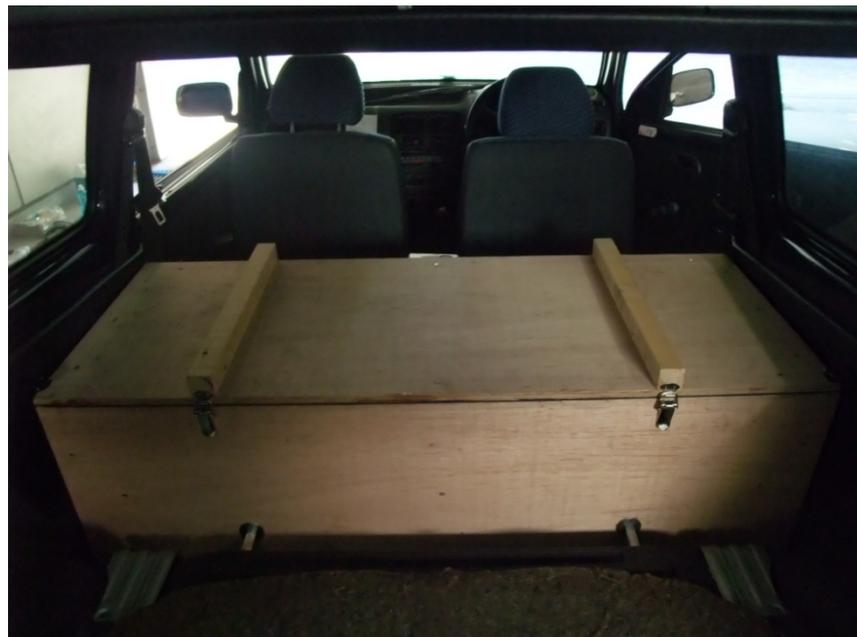
バッテリーの固定と水素ガス排出のために設置（密閉型の鉛蓄バッテリーの場合は排気口は不要）
